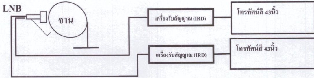
ภาพประกอบการติดตั้งจานดาวเทียม กลุ่มที่ ๒
