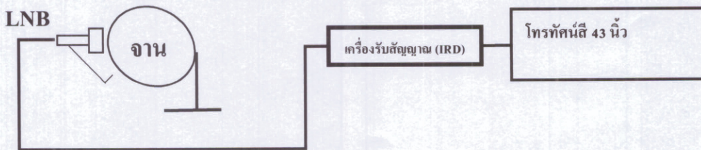
ภาพประกอบการติดตั้งจานดาวเทียม กลุ่มที่ ๑
